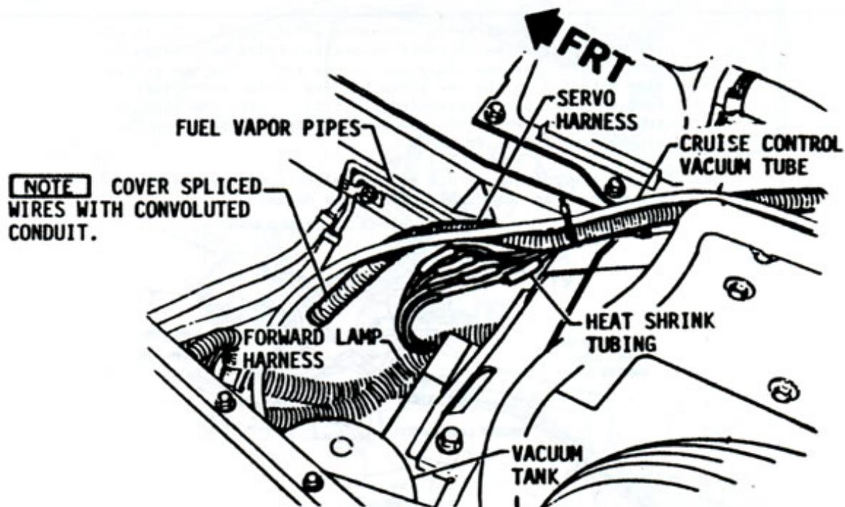
FIGURE 6. JUMPER WIRE HARNESS SPLICE
