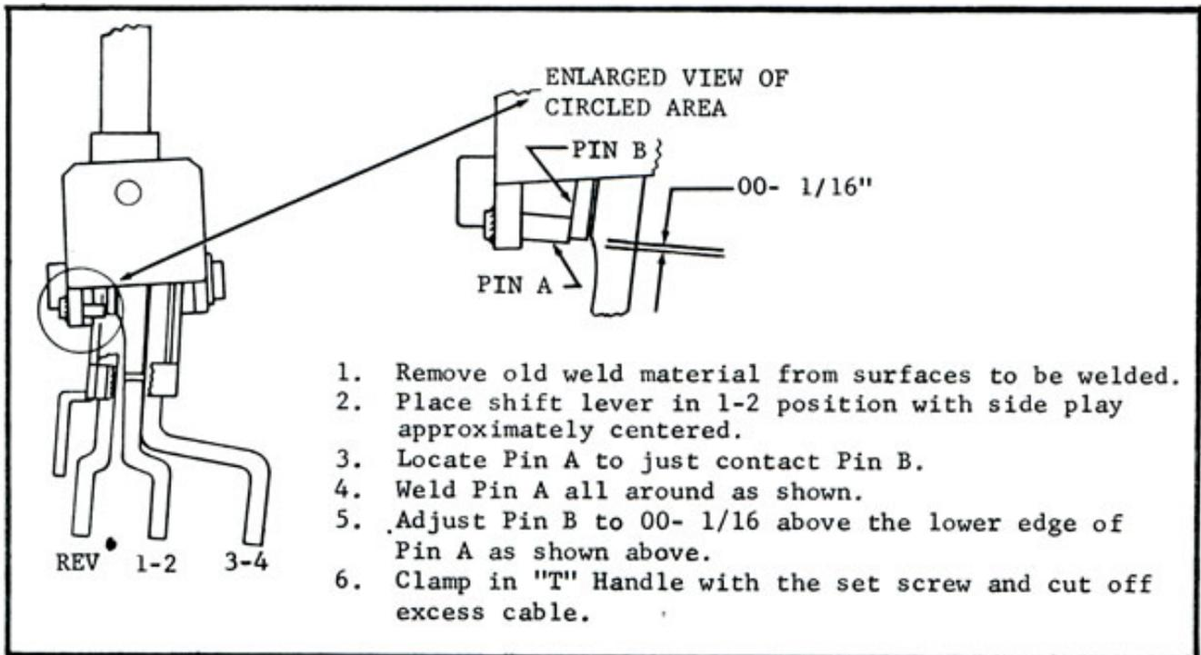
FIGURE 5 - REVERSE BLOCKER PIN LOCATING DETAILS
