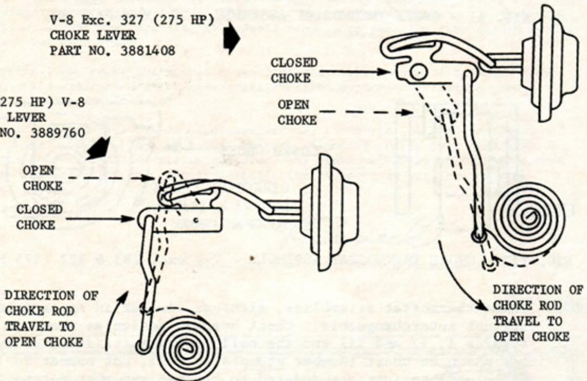
FIG. V - HOLLEY CHOKE LEVER AND VACUUM BREAK ASSEMBLY
