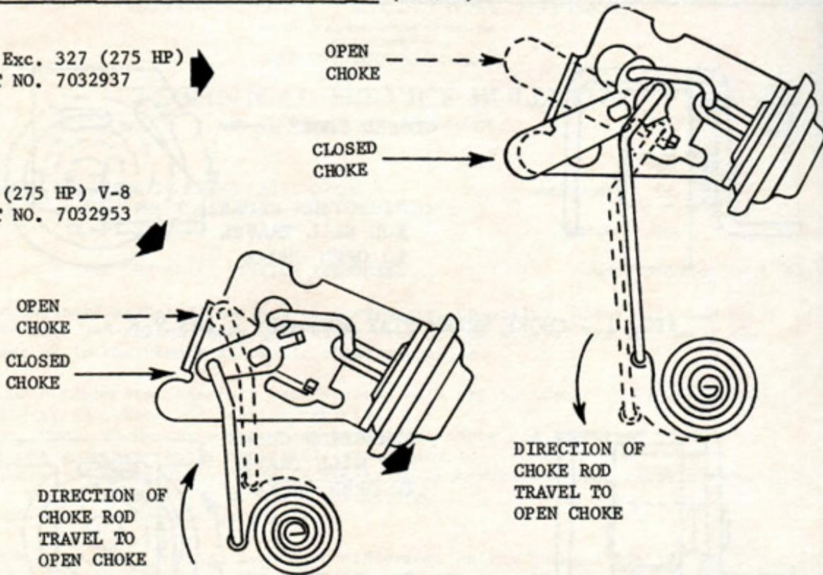
FIG. IV - ROCHESTER 4MV (QUADRA JET) VACUUM BREAK ASSEMBLY
