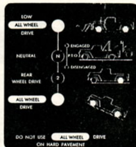
Transfer Case Shift Diagram #3757493—$.15 ea.
