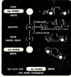
Transfer Case Shift Diagram #3757493—$.15 ea.
